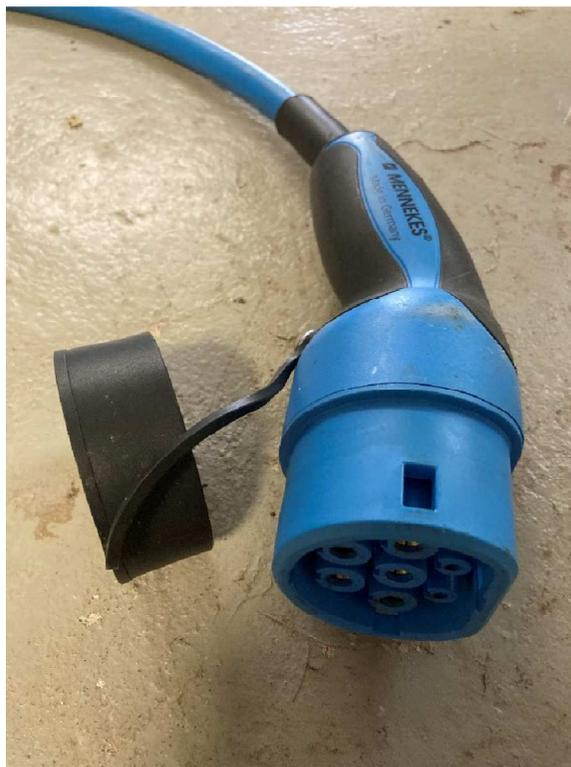
Typ 2 - Wechselspannung
