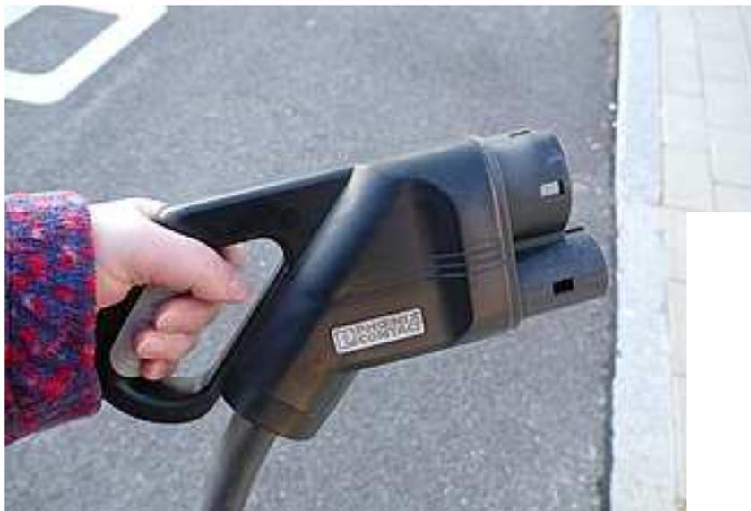
CCS (Combined Charging System) - Gleichspannung
