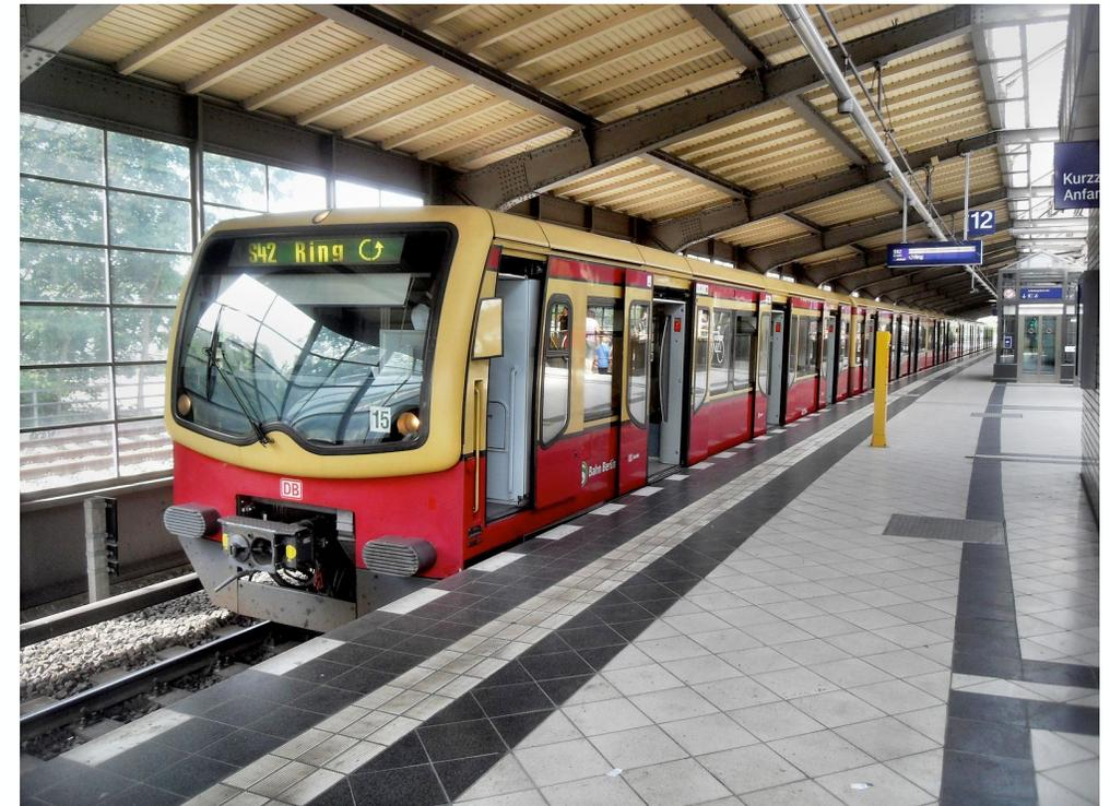
Triebwagen der DBAG-Baureihe 481 der S-Bahn Berlin auf der Linie S 42,
